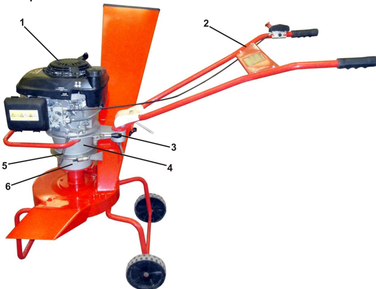
Рис. 2. Измельчитель ИМ-1 с силовым агрегатом мотокультиватора «Мастер»
