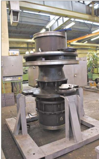
Слесарно-сборочный участок, сменно-проточная часть турбо-детандерного агрегата для охлаждения газа.
