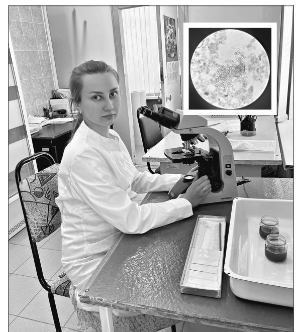
Инженер А.Р. Ражина выполняет микроскопирование активного ила.
