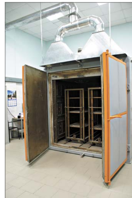
Термошкаф на участке промывки и сушки деталей.
