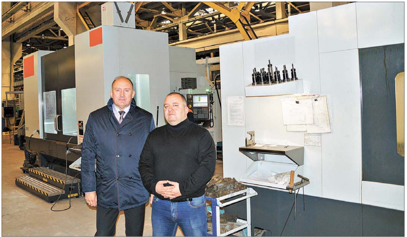
Зам. главного механика Н. И. Глазков и механик производства № 1 С. С. Гаврилов возле многофункциональных обрабатывающих центров ЕС1600 и ЕС500 фирмы HAAS для обработки крупногабаритных деталей.
