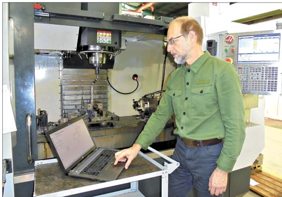
Ведущий инженер-электроник ОГМех А. В. Рулев проводит точностную диагностику оборудования с помощью системы QC-20.
